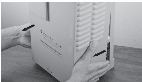
Figure 5 - Tirer sur le bas du couvercle
