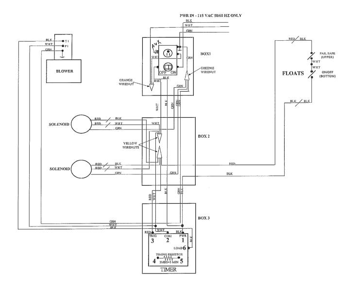
**Figure 7** AIRaider<sup>TM</sup> 321 Wiring Diagram
